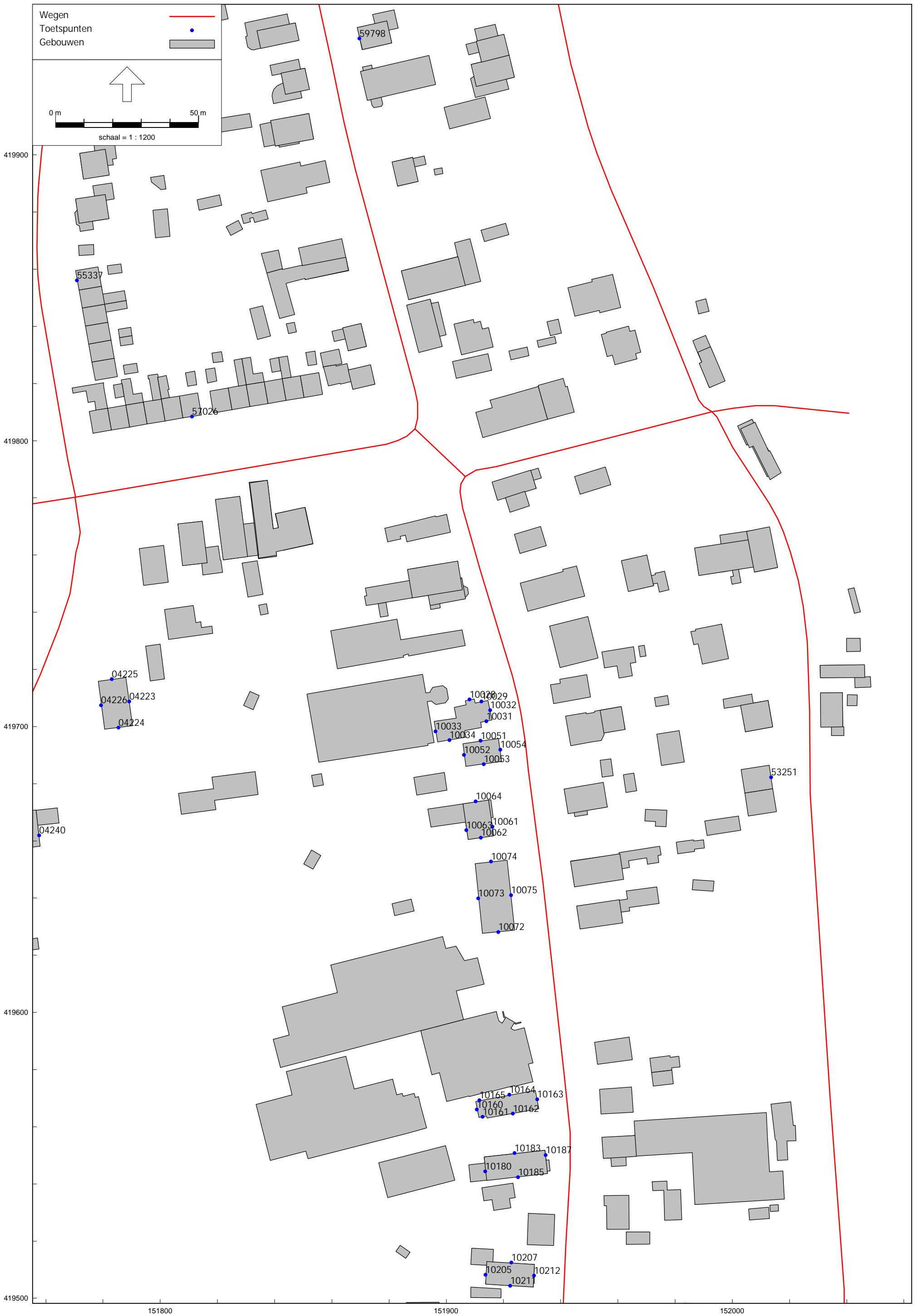
Nieuwe Zuidelijke Ontsluitingsroute in de gemeente Maasdriel - DETAIL overzicht, met genummerde rekenpunten Akoestisch rekenmodel: ingevoerde rekenpunten, in alle situaties gelijk
