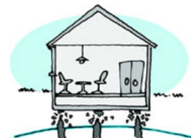
Grondwaterpeil te laag: paalrot
